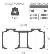
Calha para portas de correr paralelas em madeira, com possibilidade de aplicação de aba.
