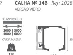
Calha para porta de correr com sistema de fixação lateral Easyclip. Versão para vidro e para madeira.
